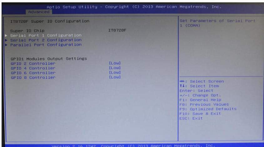
**Serial Port 1 Configuration:** 此项为串行接口1设置选项，Super IO 配置信息，包含 COM 口中断号及地址设置。
