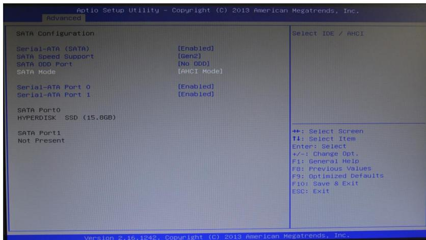
Serial-ATA (SATA) : 串行接口（硬盘接口开启enabled或关闭disabled）。
